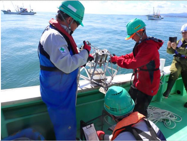
東京電力福島第一原子力発電所沖で採泥器により海底土試料を採取しているところ Collecting sediment samples by a grab sampler off the coast of TEPCO's FDNPS.
