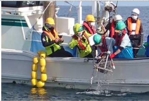
東京電力福島第一原子力発電所沖で採泥器により海底土試料を採取しているところ
