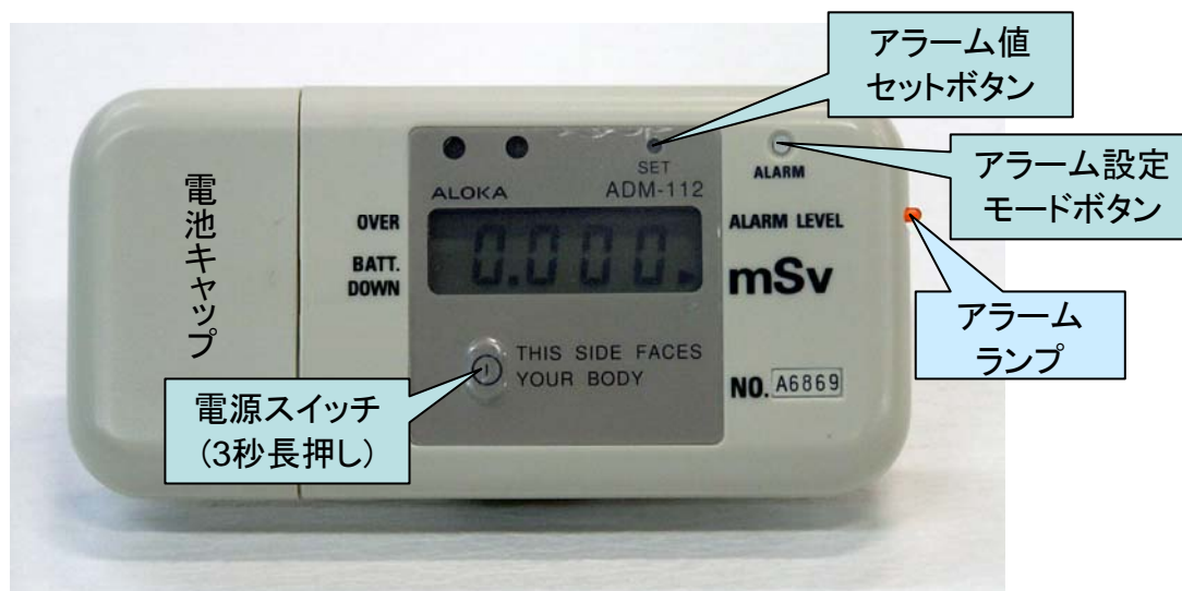
写真Ⅲ.1.1 アラーム付個人線量計（日立アロカメディカル製ADM-112型）
