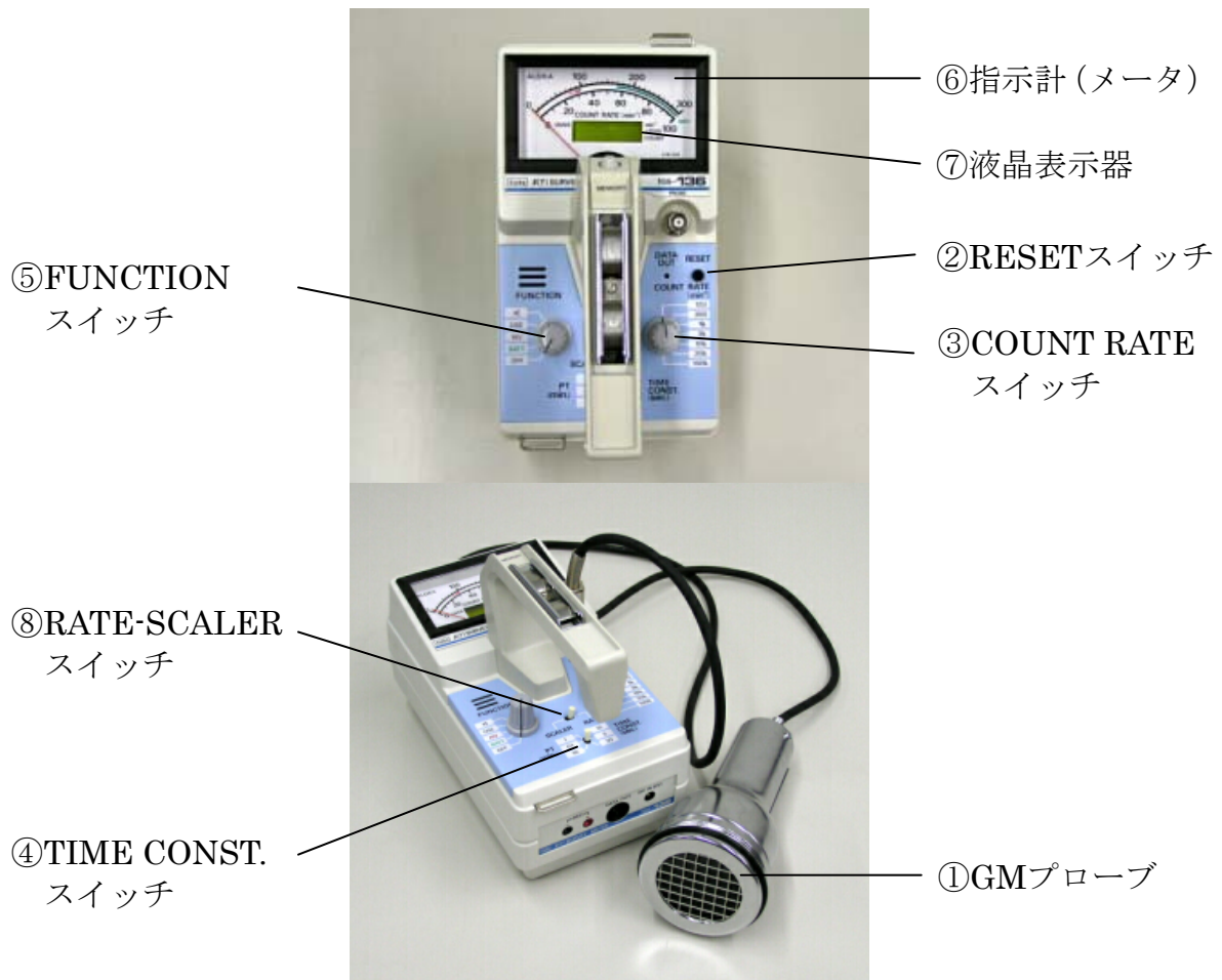
写真I.1.1 GMサーベイメータ（日立アロカメディカル製TGS-136型）
