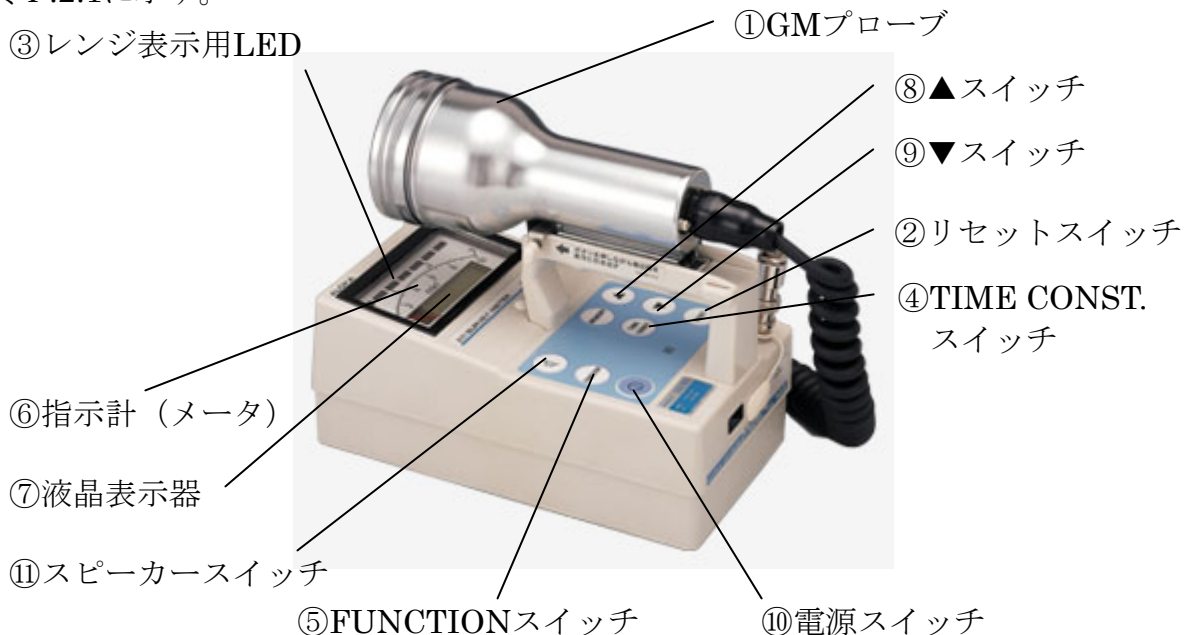
写真 I .2.1 GMサーベイメータ（日立アロカメディカル製TGS-146型）
